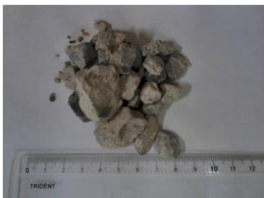
Figura 3a: RPC após o processamento primário, realizado manualmente.
