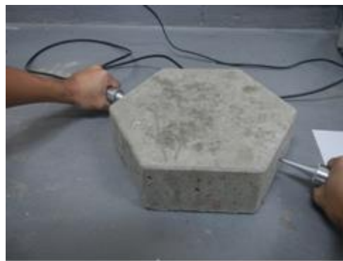
Figura 12: Ensaio de ultrassom com transdutores exponenciais.
