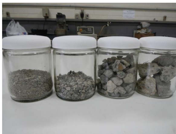
Figura 3c: RPC após pré-processamento.
