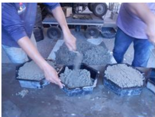
Figura 9: Moldagem dos pavers.
