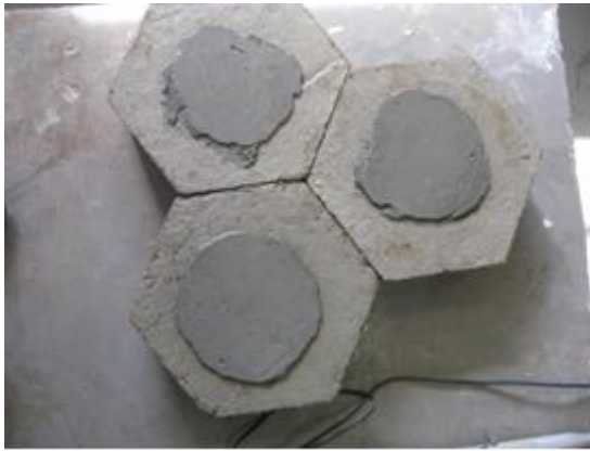
Figura 13a: Copeamento dos pavers para ensaios de compressão
