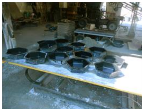
Figura 8: Fôrmas hexagonais para pavers.
