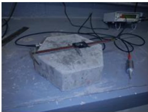
Figura 11: Determinação das dimensões dos pavers para cálculo da VPU.
