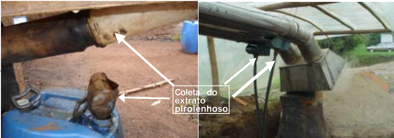
Detalhes da posição de uma chaminé para a produção e coleta de extrato pirolenhoso.
