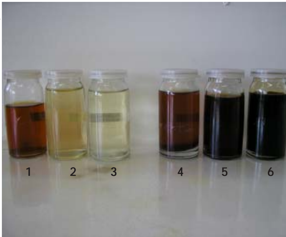
Figura 3. Amostras de líquido pirolenhoso proveniente de diferentes processos (1), decantada por seis meses e filtrada, (2) destilada uma vez, (3) destilada duas vezes ; (4) bruta sem filtração e (5,6) resíduo da decantação após 6 meses.
