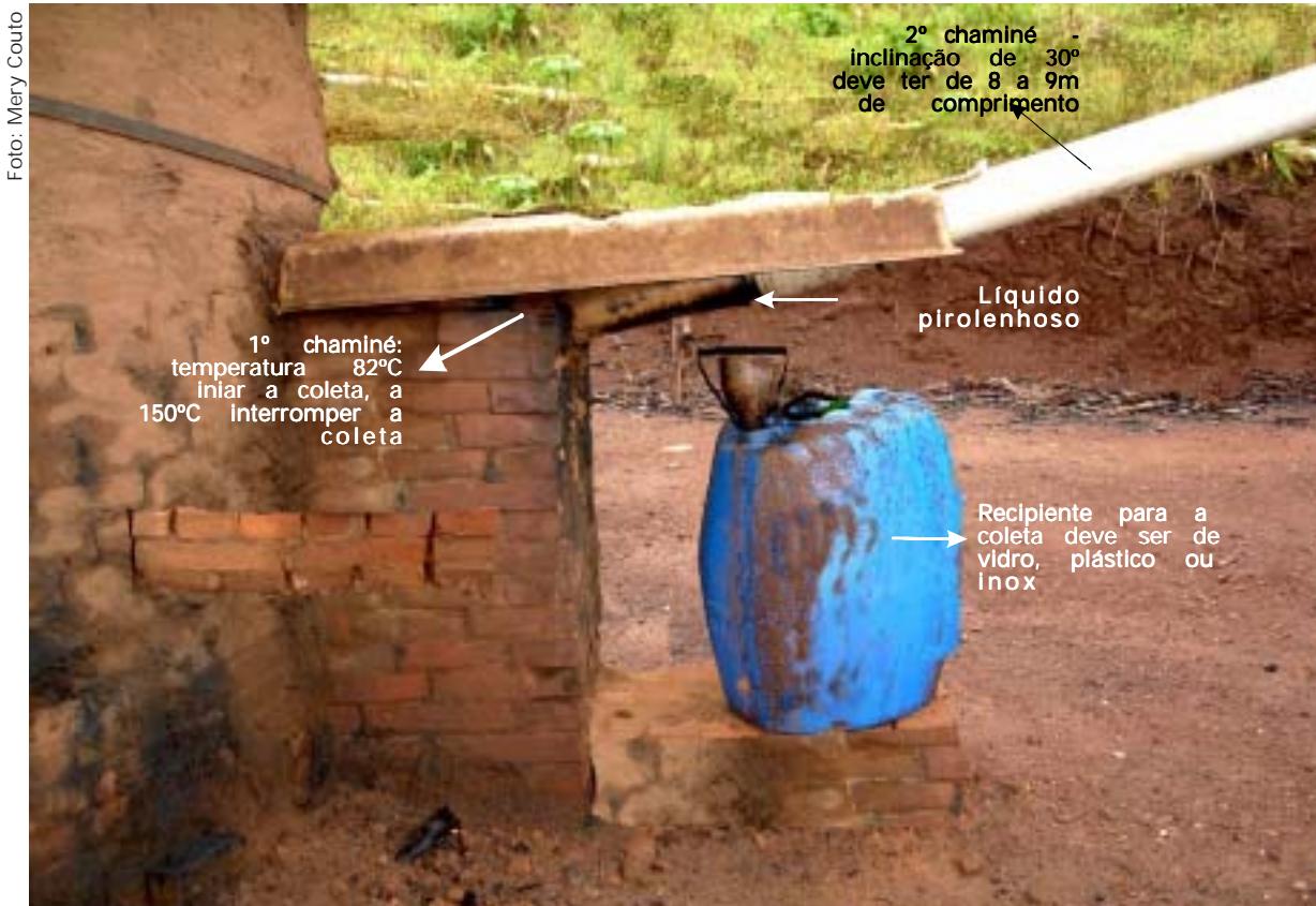
Figura 2. Adaptação de um forno para a produção do extrato pirolenhoso, onde foi construída a primeira chaminé de tijolos e foi colocada a segunda chaminé de 8m de comprimento para a condensação da fumaça.
